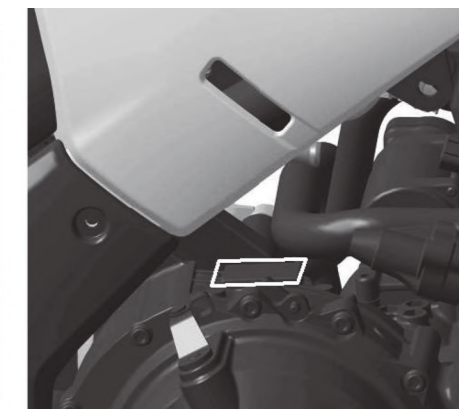
Número de identificación y tipo del motor
